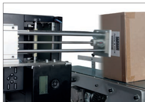
Wszechstronność aplikacji etykiet to możliwość ich naklejania poprzez kontakt mechaniczny lub pneumatycznie, z góry, z boku, lub pod dowolnym kątem obrotu osi aplikatora.
